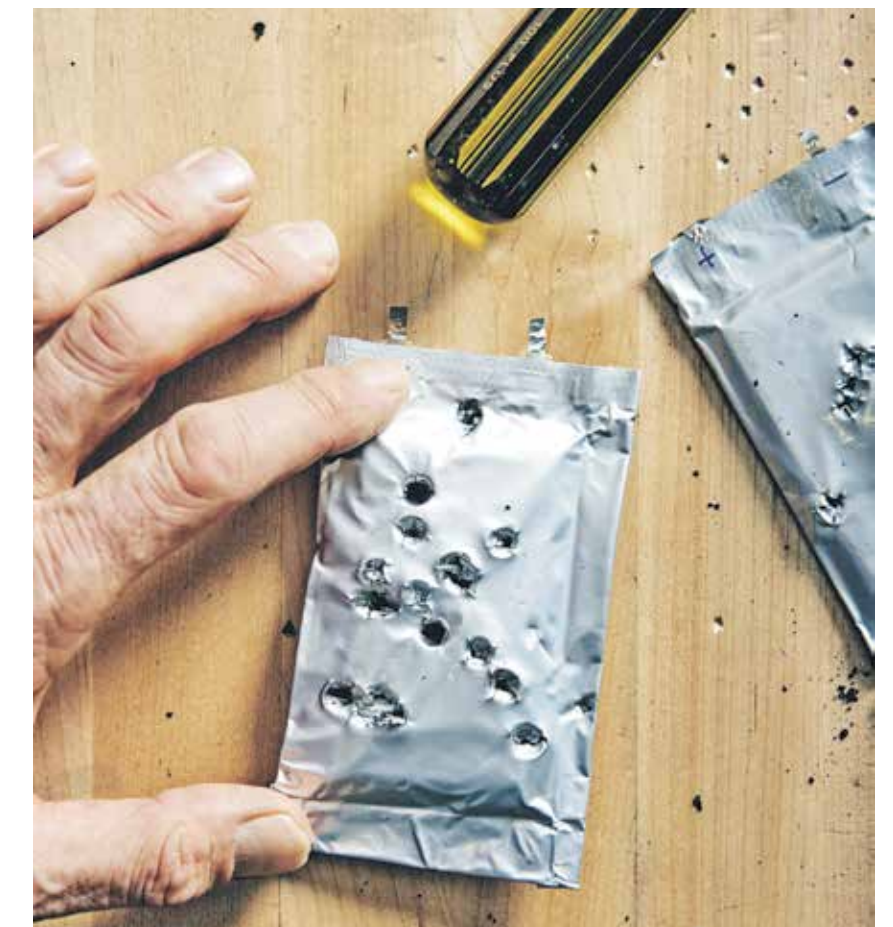
MIKE ZIMMERMAN DEMUESTRA cómo puede empujar repetidamente un destornillador a través de una batería sólida de polímero de litio metálico sin provocar un incendio u otro evento peligroso, en Woburn, Massachusetts, el 9 de diciembre de 2016. (Tony Luong / El New York Times)
