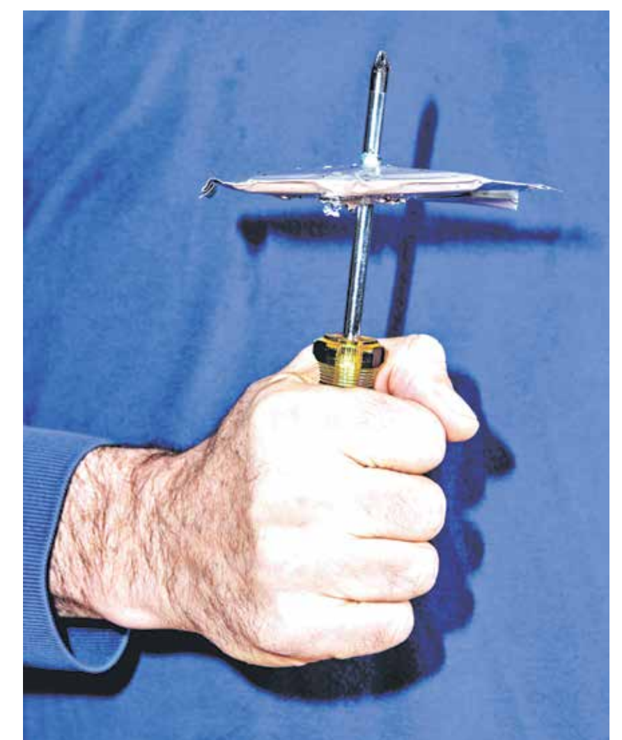
MIKE ZIMMERMAN DEMUESTRA cómo puede empujar repetidamente un destornillador a través de una batería sólida de polímero de litio metálico sin provocar un incendio u otro evento peligroso, en Woburn, Massachusetts, el 9 de diciembre de 2016. (Tony Luong / El New York Times)
