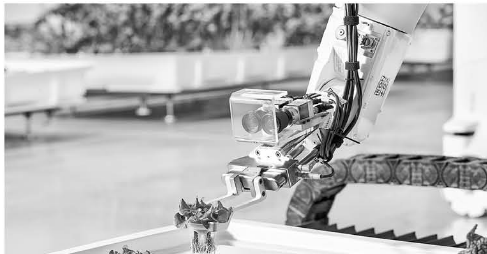
El robot Angus -en la imagen- cuenta con un software de aprendizaje automático de IA que le permite identificar y retirar las plantas con signos de estar afectadas por plagas o enfermedades Foto: Iron Ox
