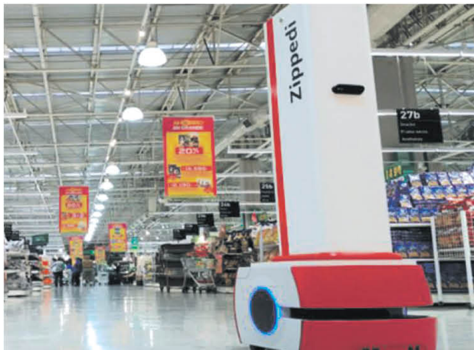
EL ROBOT ZIPPEDI, el primer desarrollo tecnológico con inteligencia artificial del país, es capaz de detectar rótulos de precios incorrectos o faltantes, stock adecuado de productos y artículos mal ubicados, entre otras funciones. (Fuente: www.innovacionchilena.cl)
