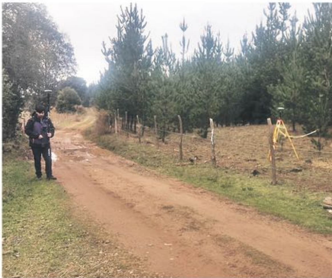
ANÍBAL MATAMALA, alumno de 5º año de Geomática, en el levantamiento topográfico de un camino vecinal, RTK con tecnología GPS. El lugar corresponde a un camino vecinal en la comuna de San Rosendo.
