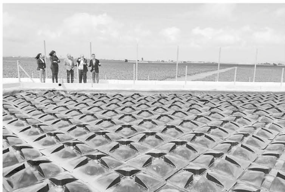
EL DISPOSITIVO CUENTA con un sistema de ventilación que favorece la condensación y dispersión del agua.
