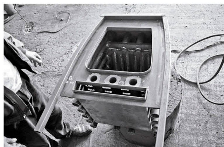
ESTUFA A PUNTO DE SER TERMINADA, se puede notar el sistema de tubos interno que logran la combustión eficiente.
