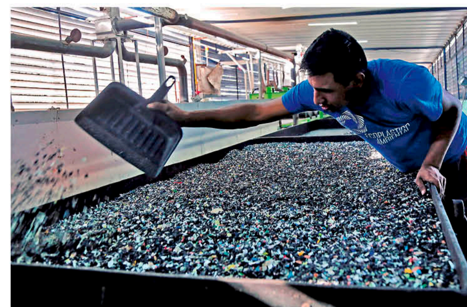
UN EMPLEADO ELABORA PLACAS DE PLÁSTICO reciclado para construir viviendas, en la localidad de Cajititlán, estado de Jalisco (México). EFE/Francisco Guasco
