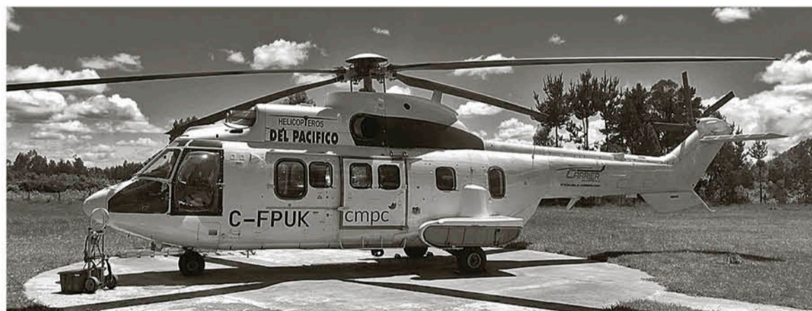
EL HELICÓPTERO ENVIADO POR CMPC descarga, con precisión, 4 mil litros de agua y puede transportar una brigada de 12 personas.
